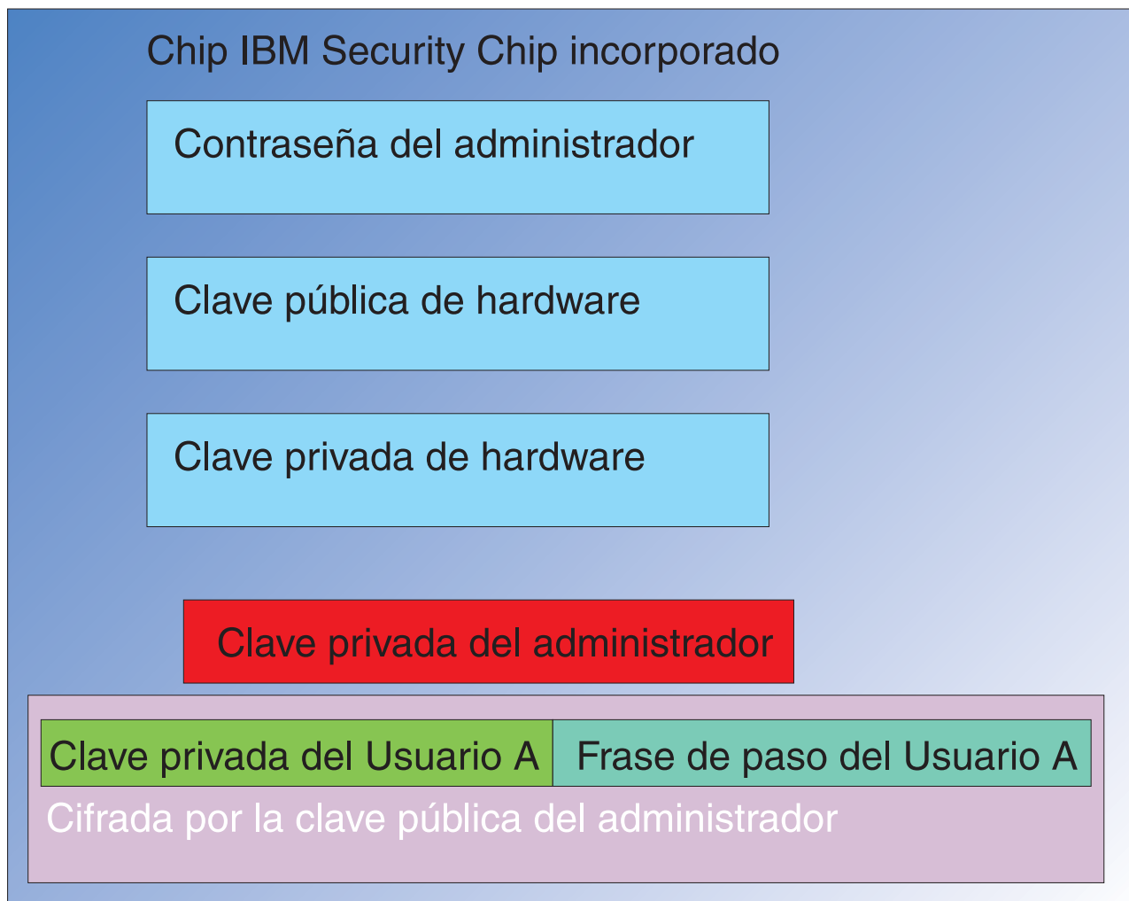
Figura 18. La clave privada del administrador se descifra en el chip.
