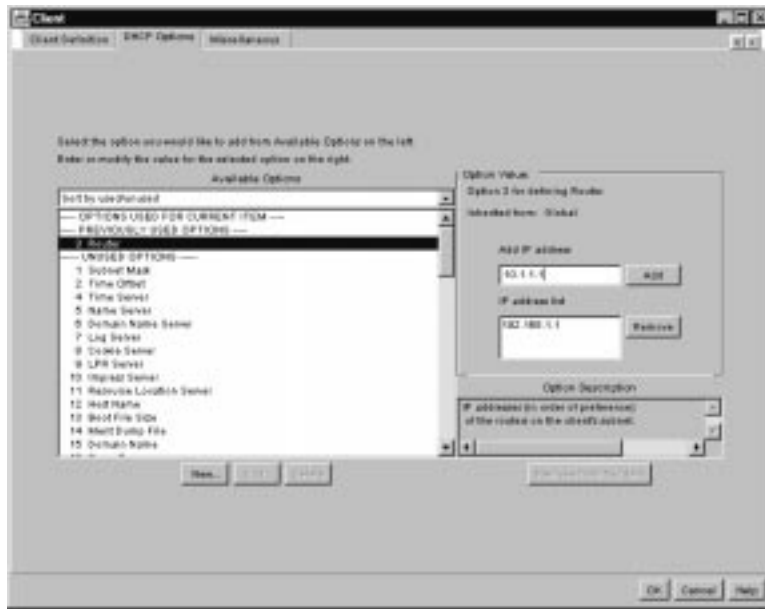
Figura 2-7. Especificar opciones de DHCP para un cliente con una dirección IP fija
