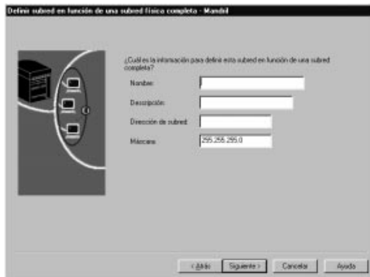
Figura 3-3. Definición de una subred completa. Configuración de ejemplo para la Figura 1-4 en la página 1-7 si NS3 y NS4 son Network Stations twinaxiales.
