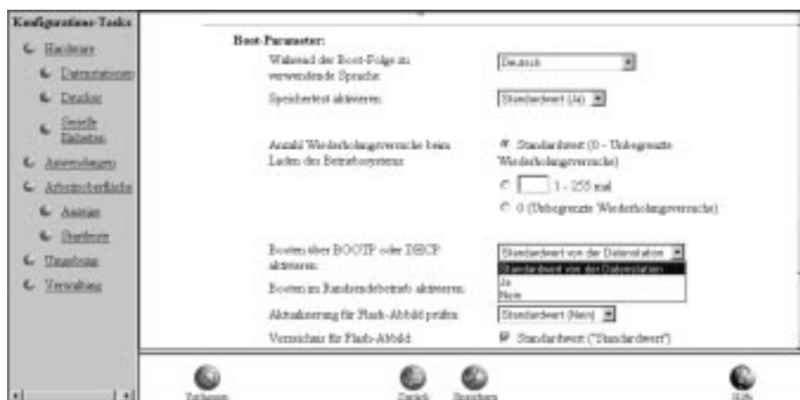
Abbildung 34. Boot-Einstellung der Network Station außer Kraft setzen
