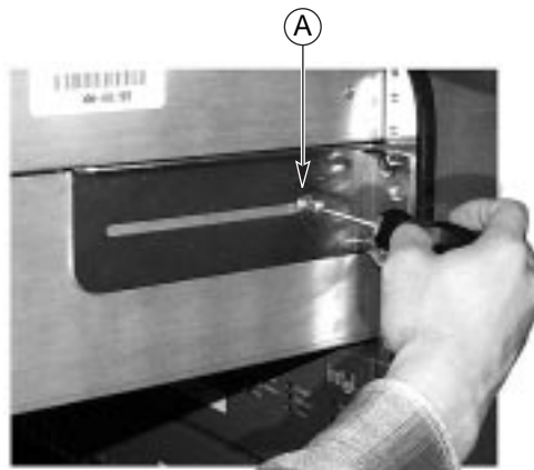
Figura 16. Il telaio viene fissato alla staffa con una vite indicata con la lettera "A"
