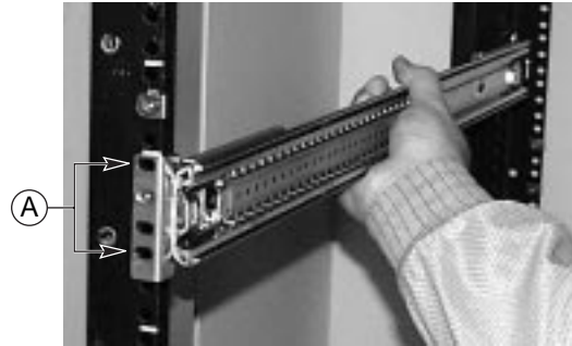
Figura 10. Gruppo di scorrimento allineato con i fori nel rack verticale
