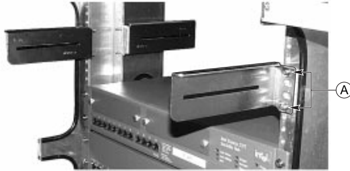
Figura 14. Staffa FR/RL collegata alla parte posteriore sinistra del rack
