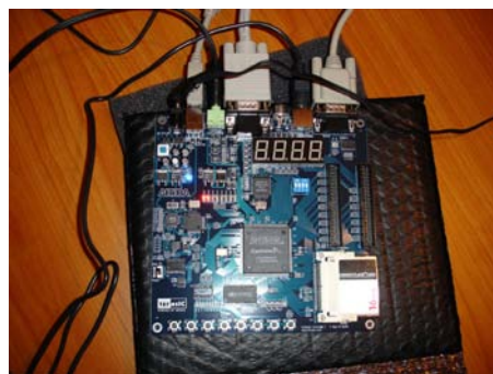
Das T-Rex Board mit nur 15x15cm läßt fast keine Wünsche bei den Anschlüssen offen.
