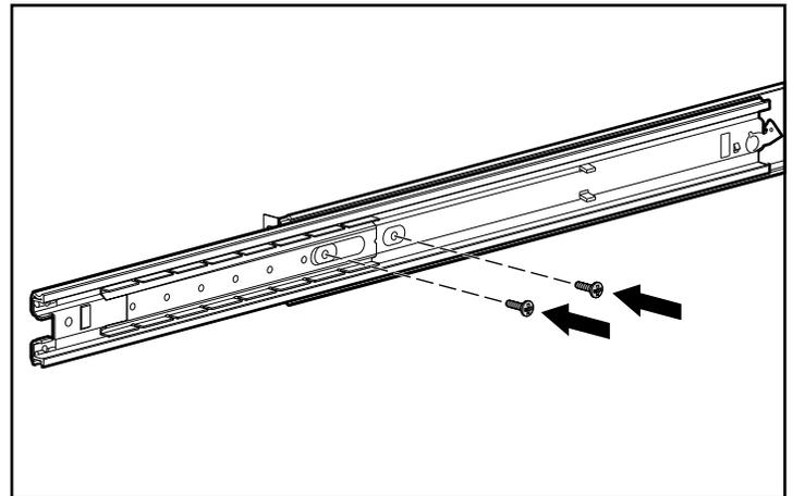
4. 残りのネジ穴にアクセスするためにレールを戻し、残りのネジを挿入して締めます。
