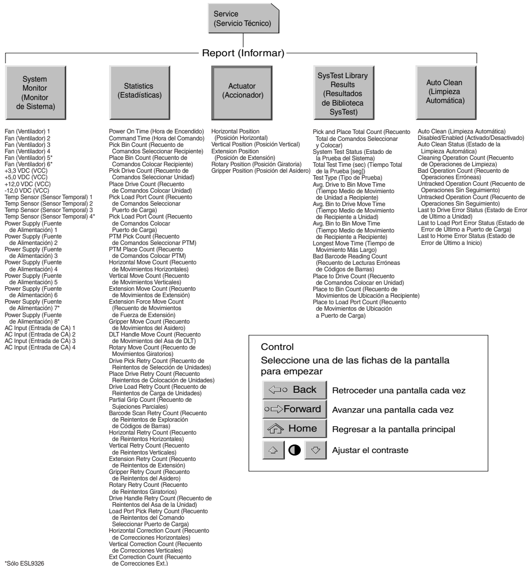
Figura 5-3: Pantalla Service (Servicio) del panel de control (1 de 2)
