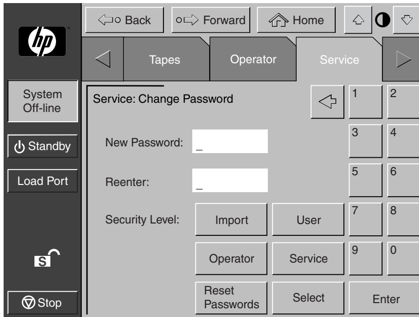
Figura 5–10: Pantalla Service: Change Password (Servicio: Cambiar Contraseña)
